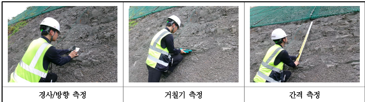
【사진 61.3.3】 불연속면 측정 현황
